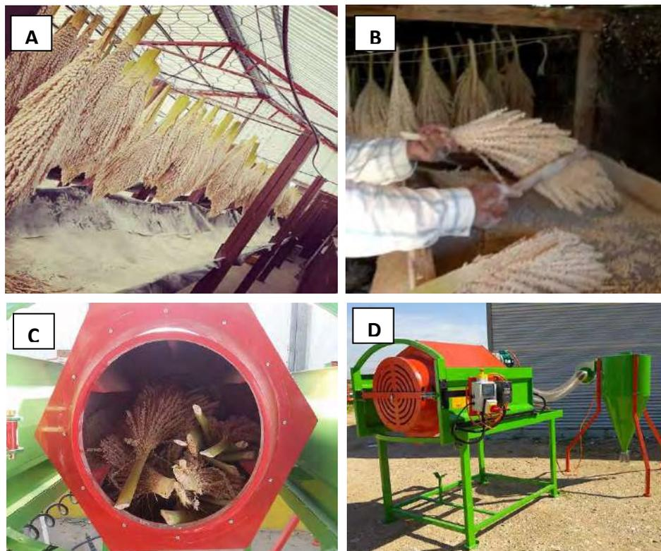
**Figura No. 4.** Extracción de polen: A) Secadero de inflorescencias masculinas de palma datilera. B) Extracción mediante golpes suaves a la inflorescencia. C) Inflorescencias dentro de una máquina extractora de polen. D) Vista lateral de un equipo completo extractor de polen. Fuente: Imagen: A y B (seaview760, 2009), Imagen C y D (AGROM, 2020).
